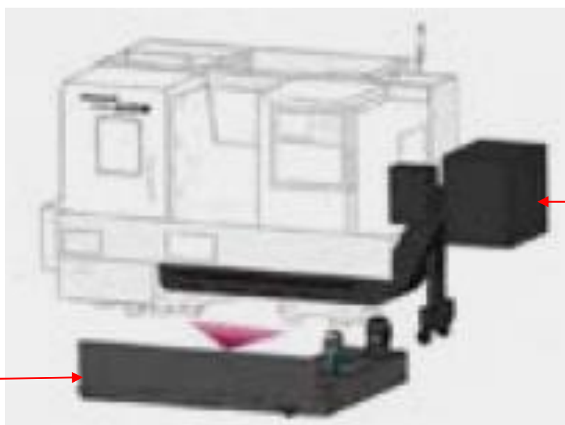
Detalhe do tanque do óleo refrigerante e transportador de cavaco
